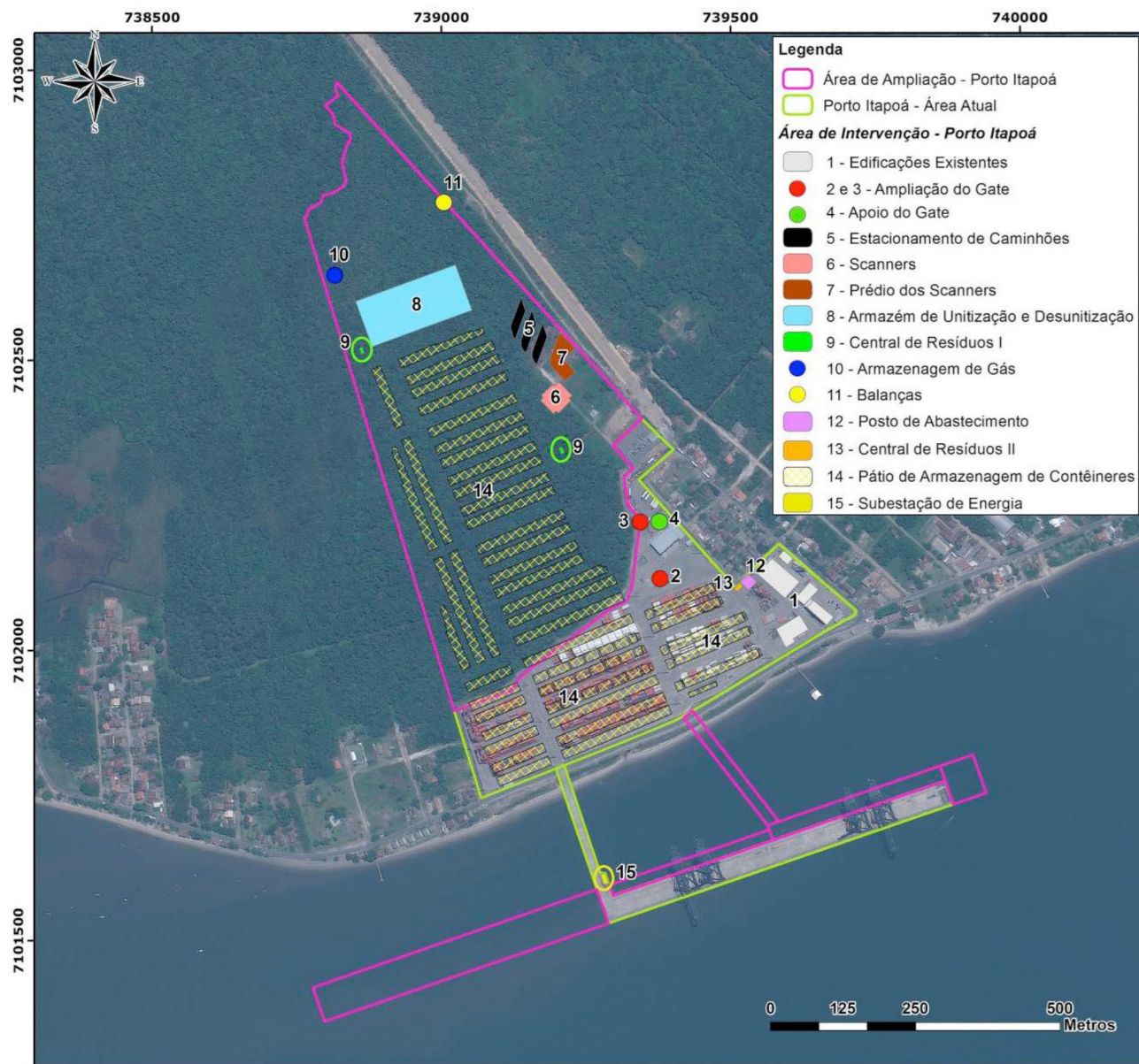
Figura 11. Locais das instalações atuais e aquelas a serem ampliadas no Porto Itapoá, Santa Catarina.
